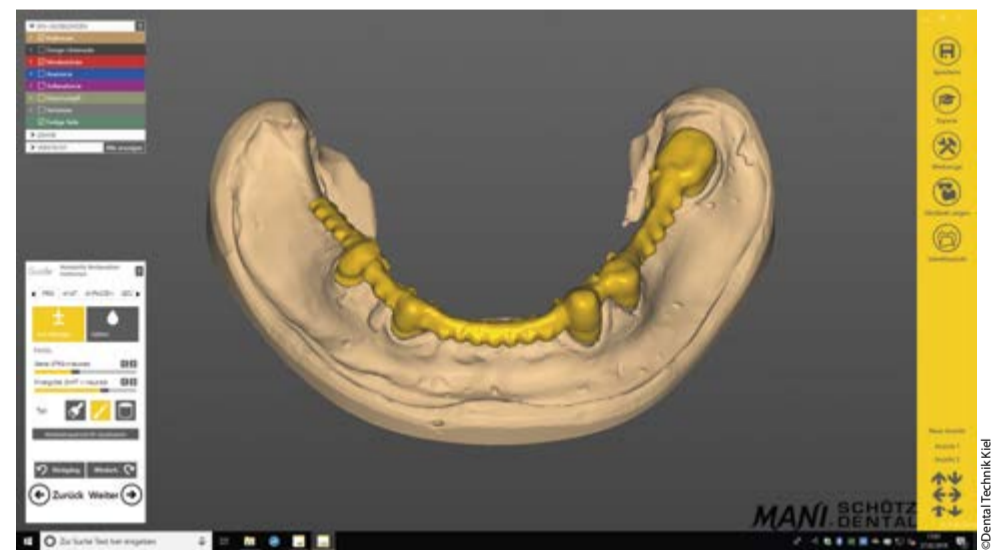
Design der Außenteleskope nach Scan zur Erstellung des STL-Datensatzes für den Fräsvorgang
